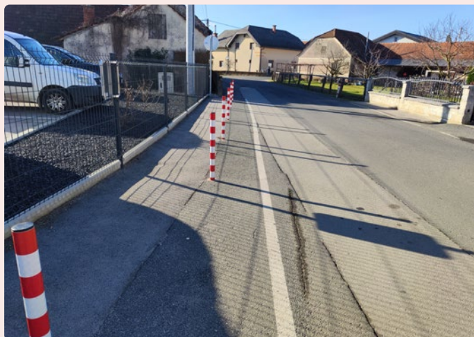
Slika 12: Stebrički za preprečevanje parkiranja na peščenem delu cestišča – zagotavljanje varnosti pešcev
