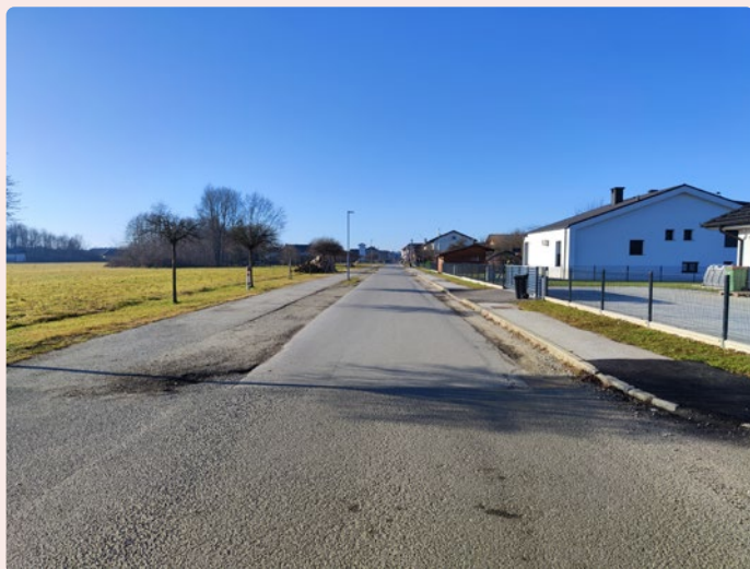
Slika 26: Prešernova ulica (pogled proti OŠ Odranci) kolesarska steza z ločilnim pasom na levi strani in deniveliran hodnik za pešce na desni strani
