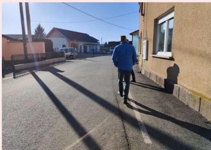
Slika 10: Nepregleden ovinek z zoženim hodnikom za pešce – pešec prisiljen hoditi po vozišču
