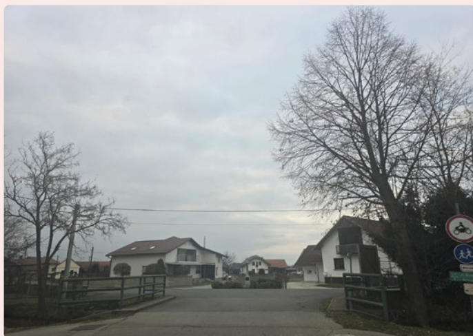
Slika 44: Nepregledno in nevarno Y križišče s pomanjkanjem ustrezne prometne signalizacije – potreba po izboljšanju vidnosti in prometne varnosti
